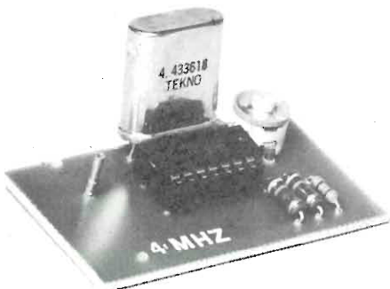
Primo piano dell'oscillatore da 4 MHz a realizzazione ultimata.
