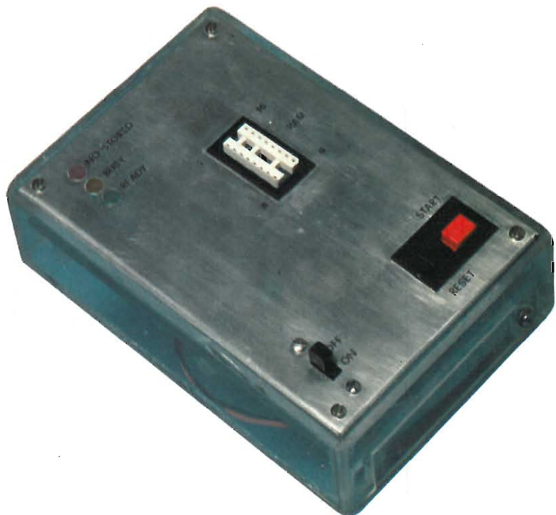
Tester per RAM a realizzazione ultimata.
